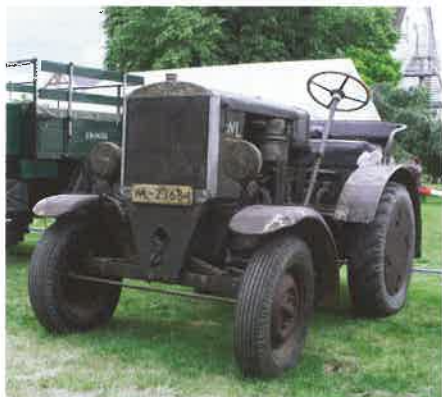
Tarn-Normag: Schlepper aus Kriegszeit mit verdunkelten Scheinwerfern.
